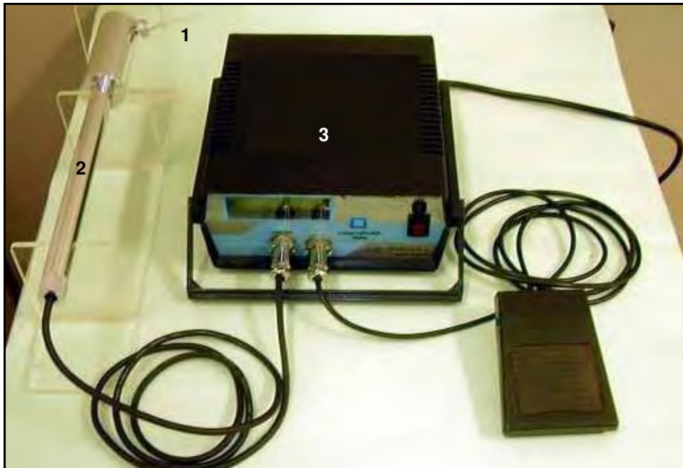
Figura 2. Analgesímetro digital. A ilustração mostra o equipamento utilizado para avaliar a hiperalgesia. Uma ponteira de polipropileno com 0,7 mm 2 (1) foi fixada a um transdutor de força (2) ligado ao aparelho de leitura (3) que converteu a força aplicada para valores em gramas.
