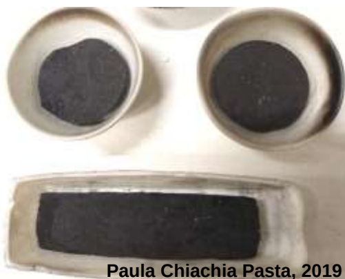
Figura 14 – Carvão ativado produzido após queima em mufla do bioissorvente (taboa).
