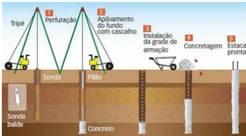
Figura 8 - Esquema de execução da estaca tipo Strauss
