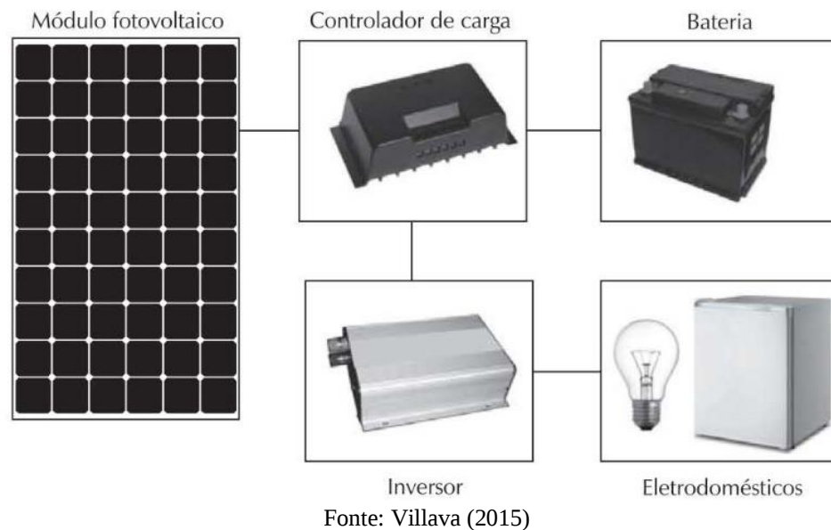
Figura 19 - Componentes dos sistemas fotovoltaicos autônomos.
