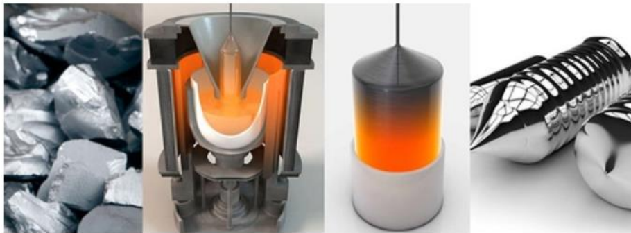
Figura 9 - Processo de fabricação dos lingotes de silício monocristalino.
