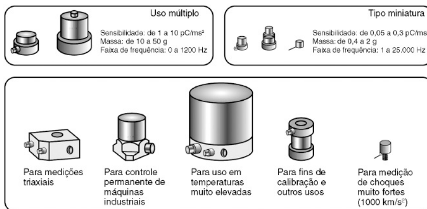
Figura 14 – Transdutores de aceleração
