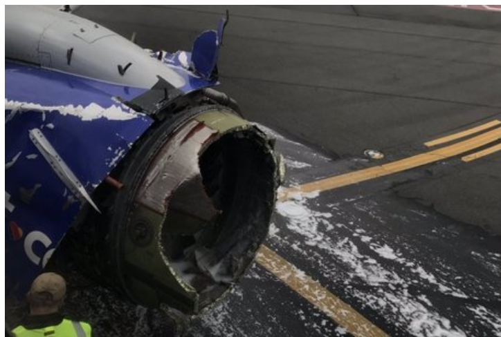
Figura 17 – Turbina destruída após explosão.
