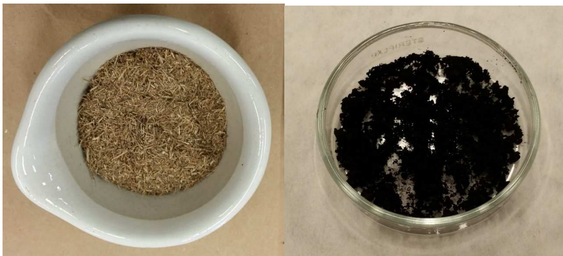
Figura 1 Biomassa do pseudocaule de bananeira in natura e torrefada.
