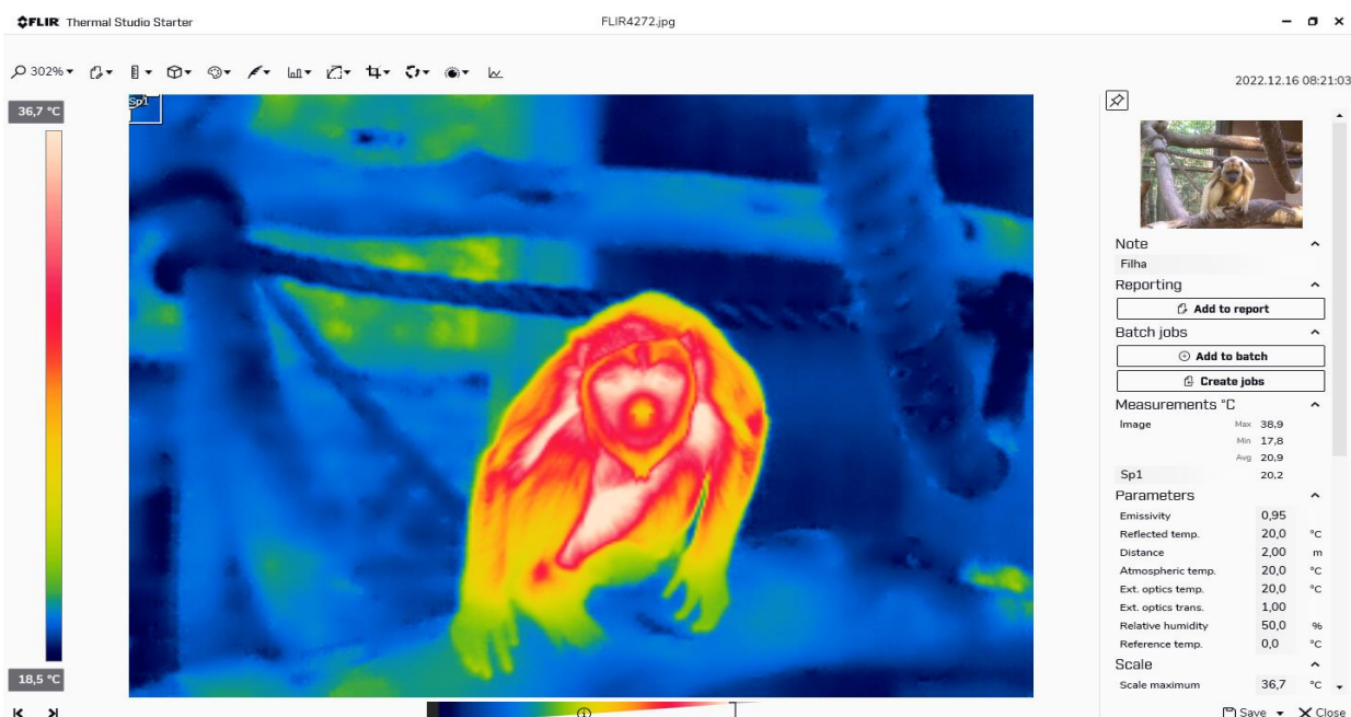
FIGURA 1 – Imagem termográfica de bugio-preto fêmea no software . É possível comparar as cores no animal com as cores padronizadas na barra multicolorida do padrão Rainbow , à esquerda da foto. No padrão estabelecido o azul escuro representa temperaturas mais baixas (18,5°C) e o branco temperaturas mais altas (36,7°C). Foto: André L.M. Costa.
