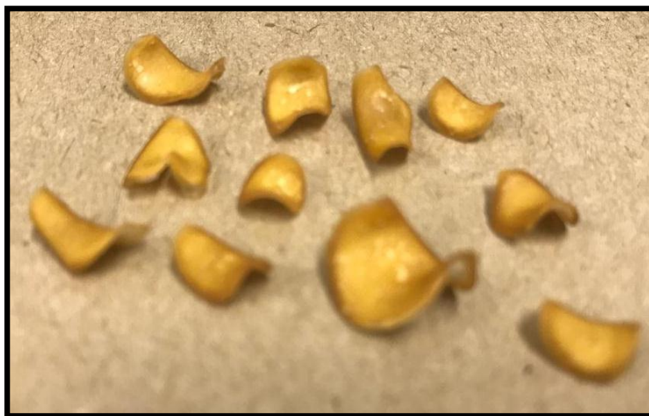
Figura 10. Amostras QS60C feitas pelo método casting
