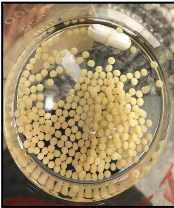
Figura 7. Esferas de QS60G imersas em solução coagulante
