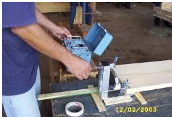
Figura 4 – Método das ondas de tensão.
