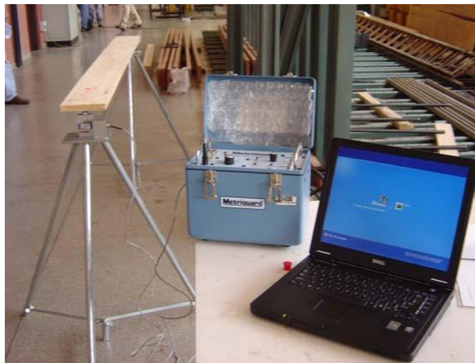
Figura 3 – Método de vibração transversal.
