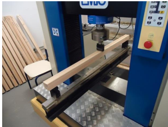
Figura 13 - Realização do ensaio de um corpo de prova de flexão estática.
