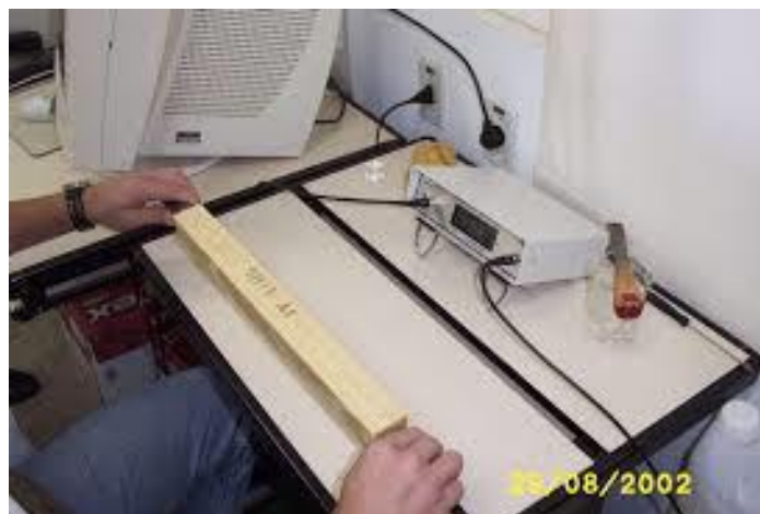
Figura 5 – Método da propagação de ondas de ultrassom.
