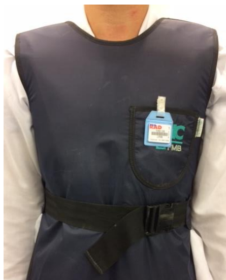
Figura 2: Modo de uso do dosímetro individual.
