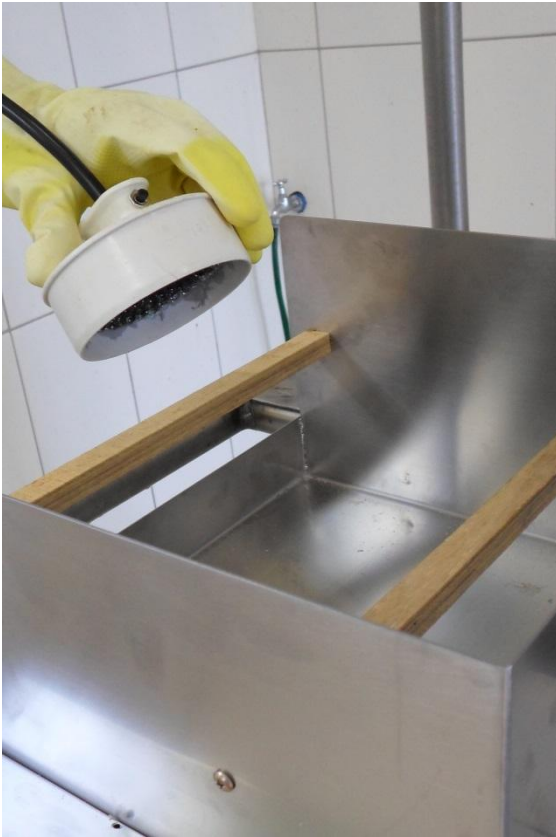
FIGURA 4 - Sistema de atordoamento por contato direto. Capacete eletronnarcótico (acima) e cuba para contenção física e condução elétrica (abaixo).
