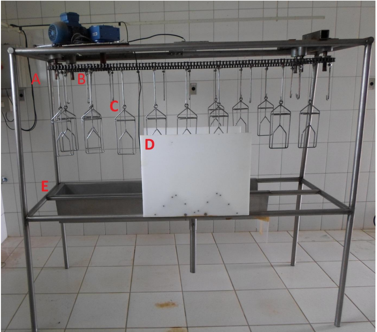
FIGURA 3 - Sistema de atordoamento elétrico em cuba d'água. A: Painel elétrico (ao fundo). B: Transportador aéreo de abate – nória. C: Ganchos. D: Cuba d'água. E: Calha de sangria.
