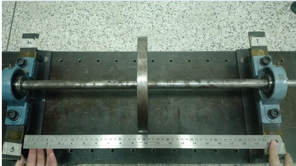
Figura 20: Montagem do rotor com disco centrado
