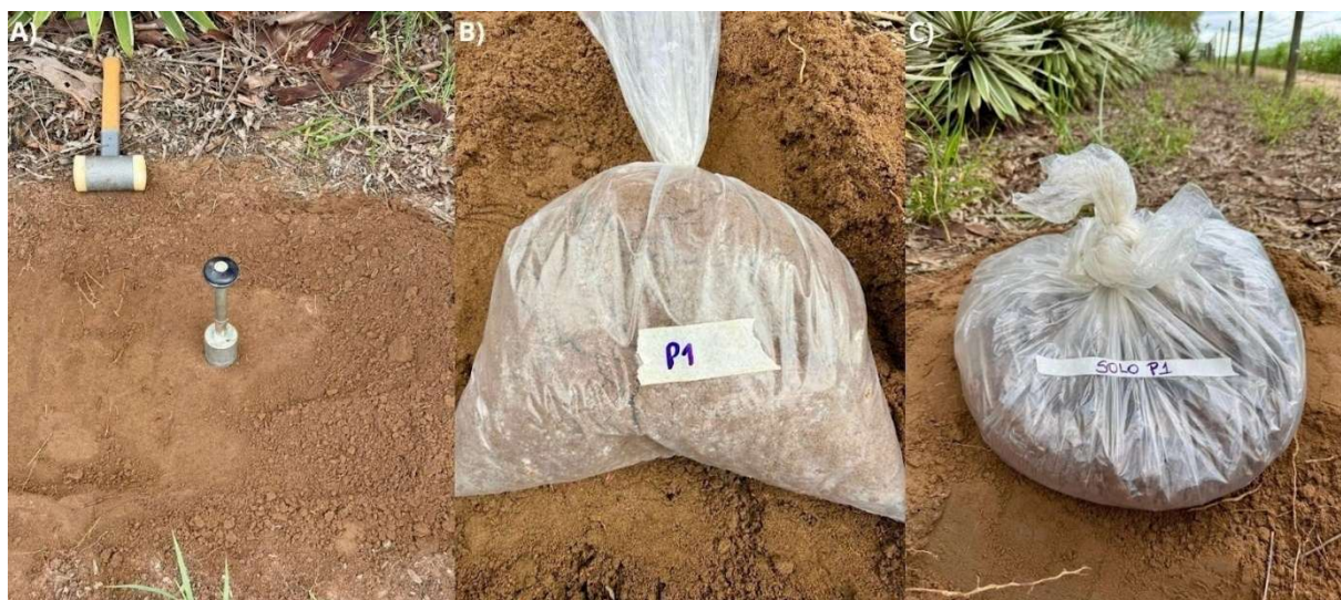
Figura 6 - Procedimento de coleta do solo: a) coleta com anel volumétrico; b) acondicionamento das amostras para análise laboratorial; c) acondicionamento do solo destinado aos vasos
