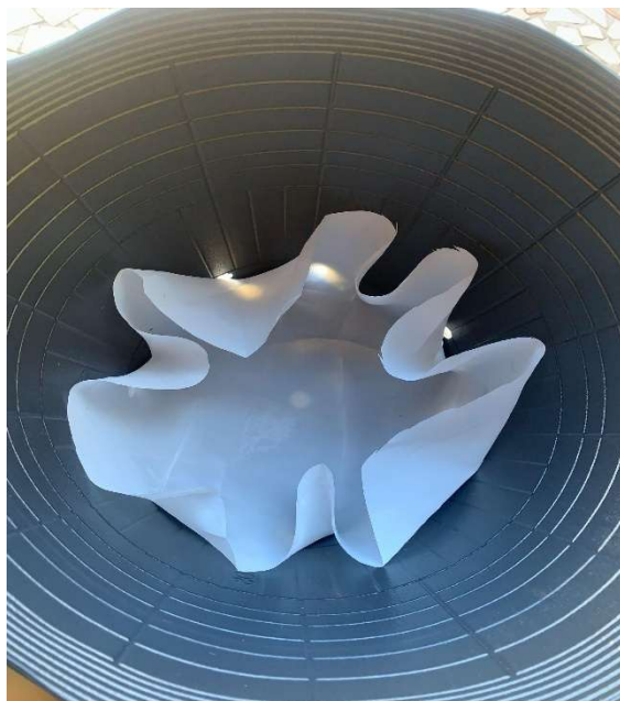
Figura 18 - Fundo do vaso com malha de poliéster (200 mesh ) para retenção de partículas
