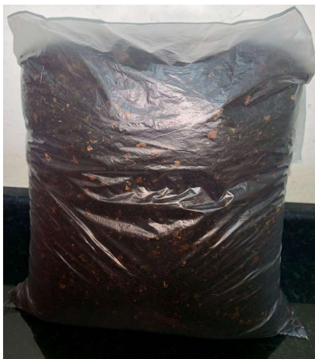
Figura 14 - Amostra representativa de composto orgânico após peneiramento em malha de 4 mm
