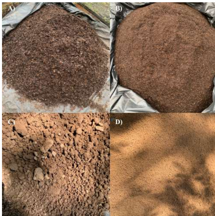
Figura 17 - Peneiramento do solo e composto orgânico: a) composto orgânico retido na peneira; b) composto orgânico peneirado; c) solo retido na peneira; d) solo peneirado
