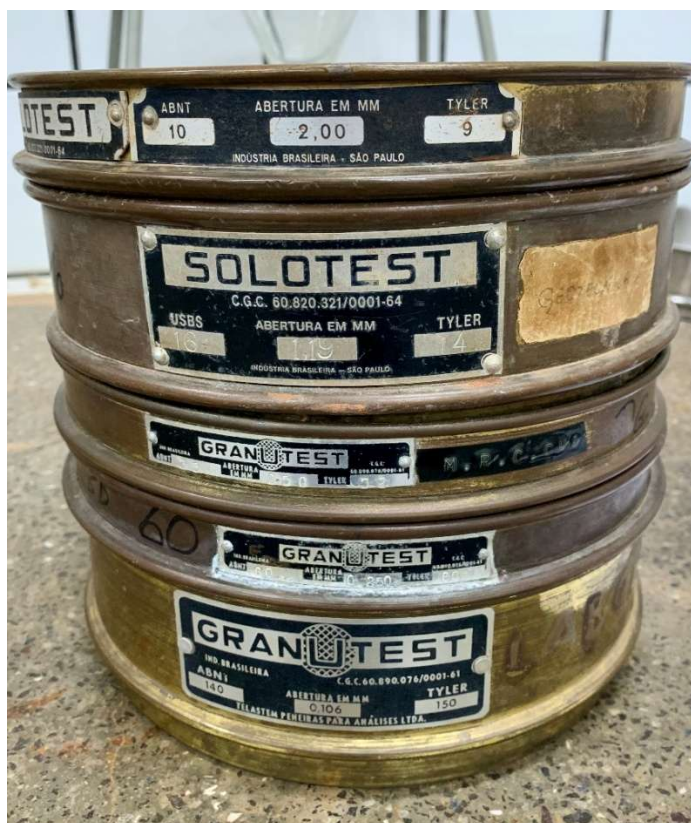
Figura 10 – Conjunto de peneiras utilizadas na determinação do índice de estabilidade de agregados (IEA)
