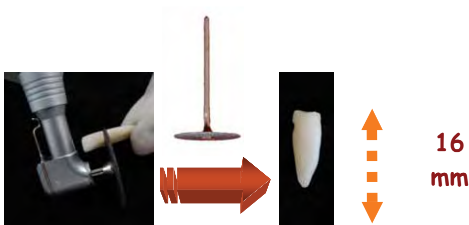
Figura 1 – Corte e padronização dos espécimes.
