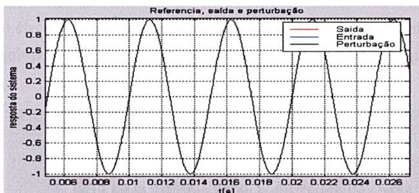
Figura 21: Perturbação senoidal de 200 Hz, cavitação na turbina, referência senoidal. (coincidem: entrada, saída e perturbação)
