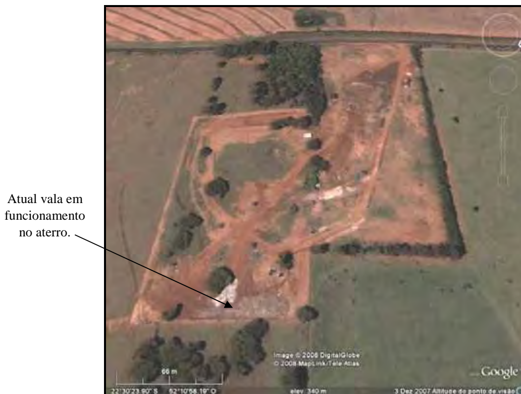
Figura 4. Valas para disposição dos resíduos sólidos urbanos em Teodoro Sampaio-SP Fonte: Fagundes, 2007.
