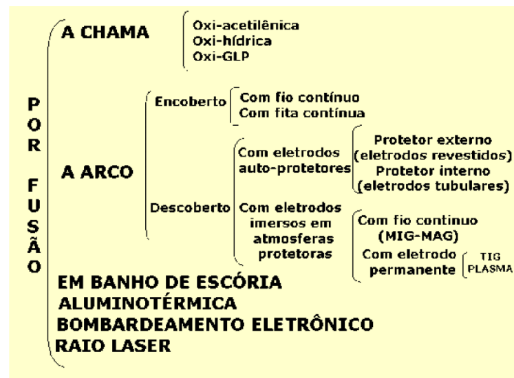
Figura 15 - Classificação dos processos de soldagem por fusão
