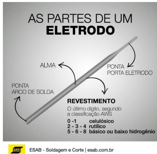
Figura 25 - Partes do eletrodo
