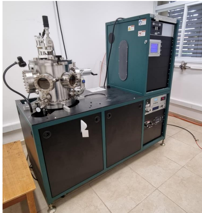
Figura 20. Equipamento sputtering presente no LCGRS na FCT UNESP campus de Presidente Prudente (Fonte: autor).
