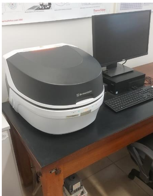
Figura 16. Equipamento de Fluorescência de raios X pertencente ao LCGRS na UNESP campus de Presidente Prudente (Fonte: autor).
