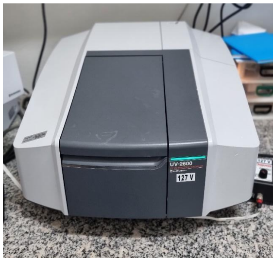
Figura 26. Espectrofotômetro UV-Vis presente no LaCOM na FCT UNESP campus de Presidente Prudente (Fonte: autor).
