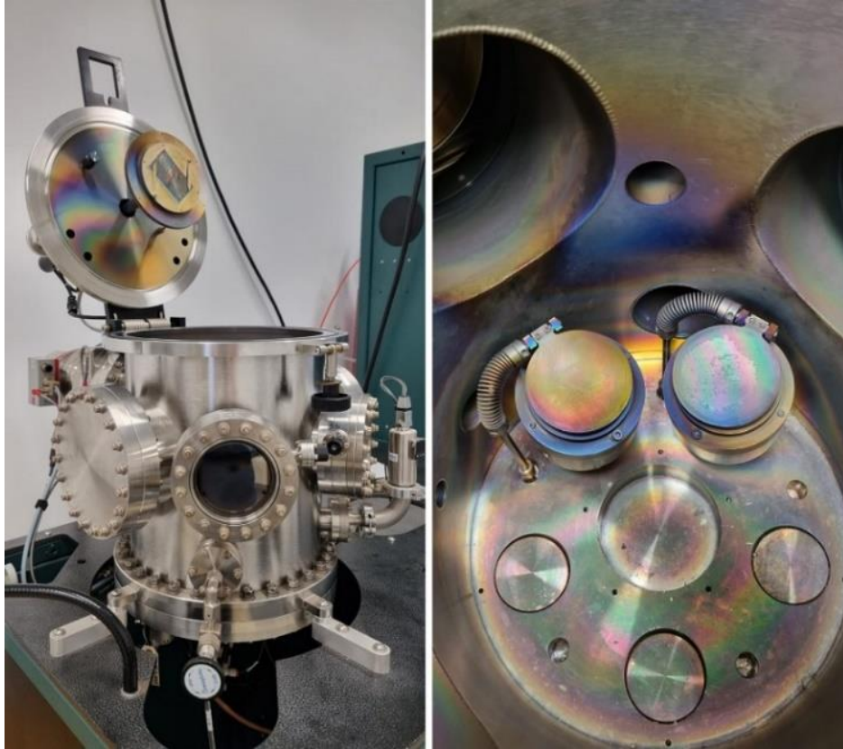
Figura 21. Detalhes da câmara de vácuo do sputtering, vista de fora (à esquerda) e vista de dentro (à direita) (Fonte: autor).
