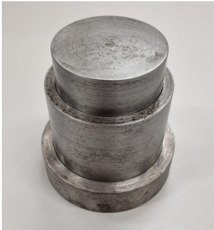
Figura 22. Molde utilizado na fabricação dos alvos (Fonte: autor).
