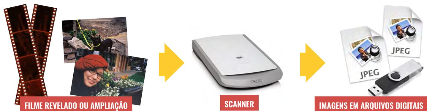
Figura 10 – Diagrama ilustrando o processo de digitalização de imagens através do escaneamento
