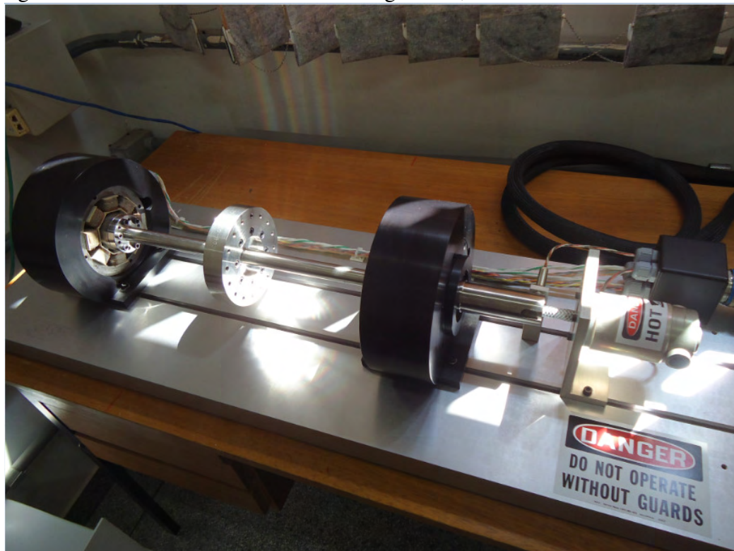
Figura 51 - Bancada contendo mancais magnéticos, eixo e rotor com acionamento
