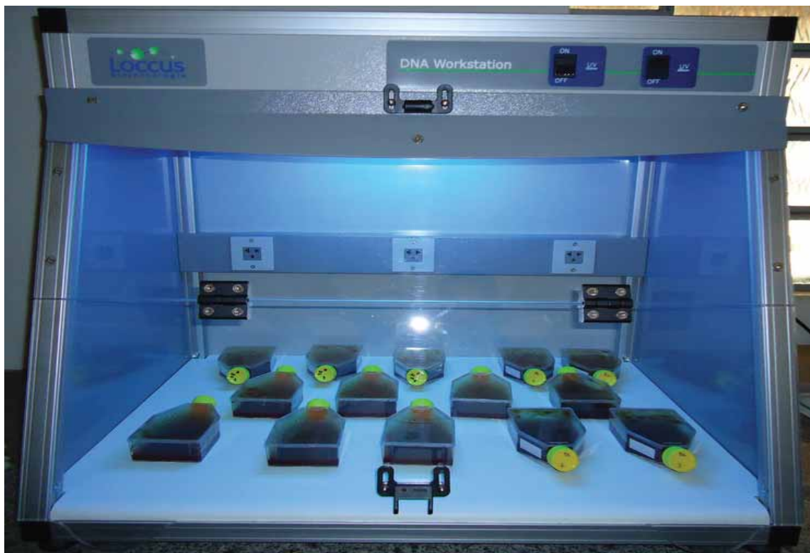
FIGURA 2. Tratamento do sangue parasitado com Anaplasma marginale na tentativa de inativação com Riboflavina associada à radiação ultravioleta.
