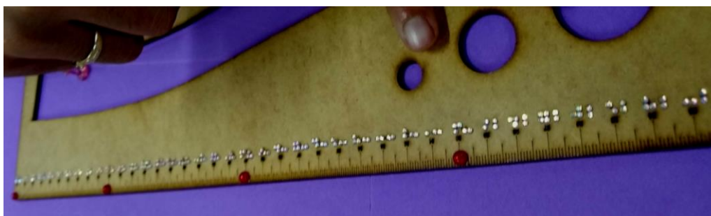
Figura 37 – Régua de modelagem adaptada com inserção de Strass.
