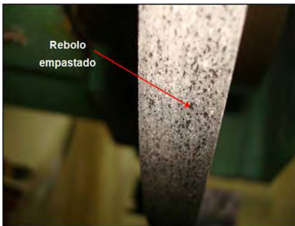
Figura 27 - Fotografia do rebolo empastado com poros entupidos, antes do início de cada ensaio.
