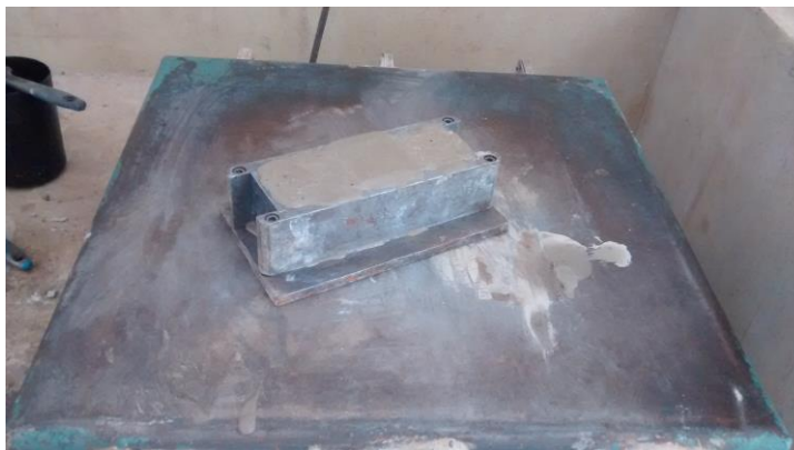
Figura 16 – Procedimento de moldagem das argamassas em fôrmas de aço na mesa vibratória
