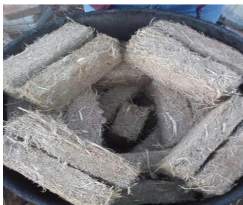
Figura 14 – Colocação do BSC no forno
