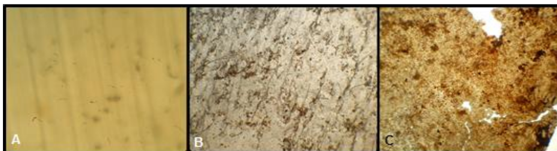
Figura 28 - Micrografias de M.O. dos filmes de PHBV/PP-co-PE/Aditivo
