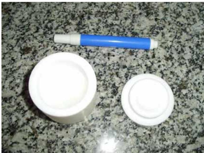
**Figura 7:** Potes de teflon utilizados no ataque químico de NaOH.
