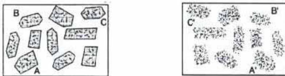
**Figura 9:** À esquerda a amostra com minerais e à direita o detector externo. A, B e C são os grãos de referência que tem seus correspondentes na mica A', B' e C' (modificado de Gallagher *et al.* 1998).
