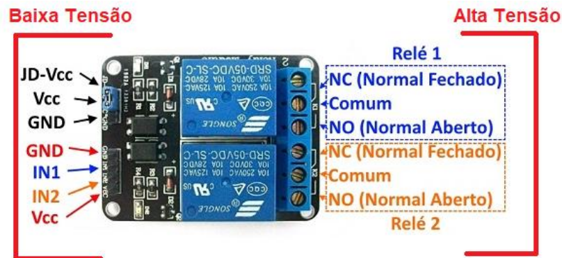
Figura 17 - Pinagem do módulo relé duplo
