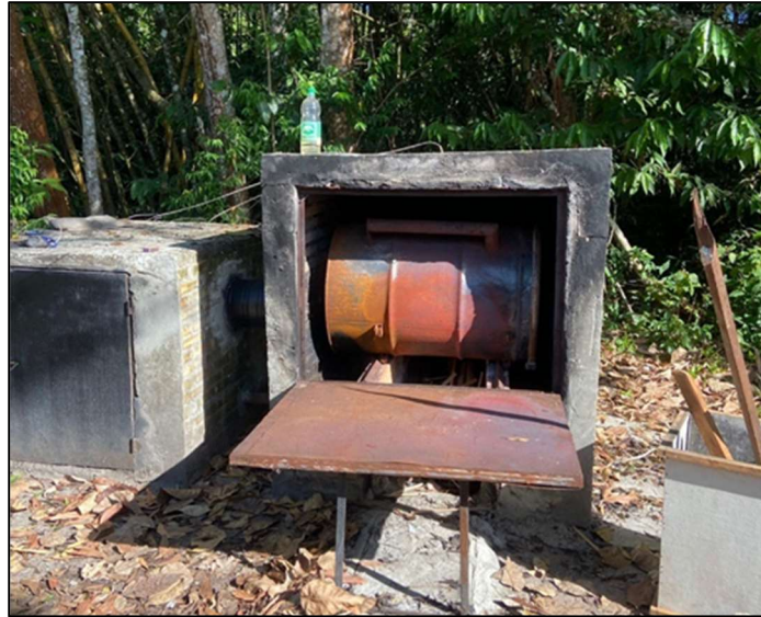
Figura 2. Forno e cilindro metálico empregados no processo de carbonização dos resíduos
