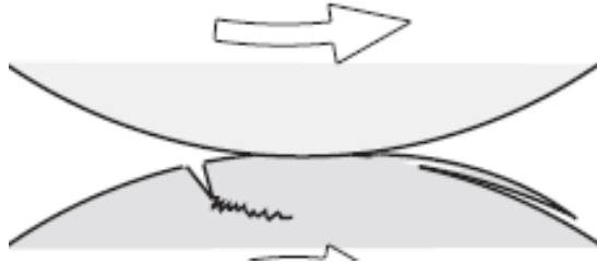
Figura 8: Mecanismo de desgaste – Desgaste por fadiga
