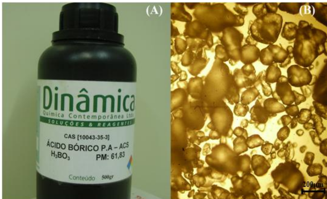
Figura 46: (A) Recipiente de ácido bórico, (B) Partículas microscópicas de ácido bórico variando de 50 a 600 \mu\text{m} .
