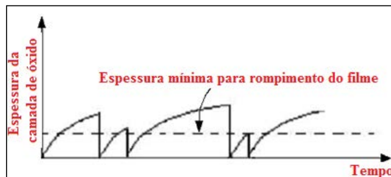
Figura 11: Visão esquemática do processo de desgaste corrosivo, onde é assumido que o óxido é frágil e sai completamente.
