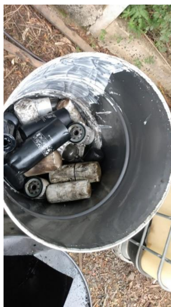
Figura 7 – Filtros de óleo lubrificante utilizados e armazenados em barris
