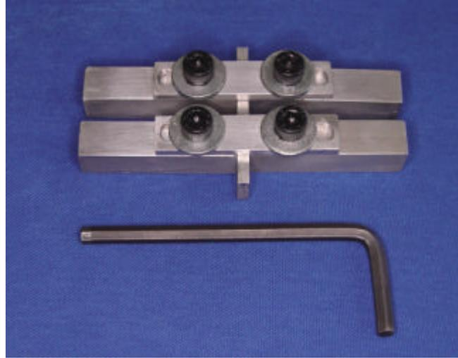
FIGURA 1: Conjunto matriz metálica, lâmina espaçadora, placas de união, parafusos e chave Allen para fixação dos mesmos.
