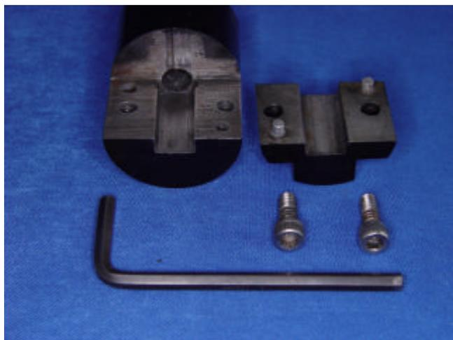
FIGURA 15: Vista aproximada do sistema de apreensão dos corpos de prova.
