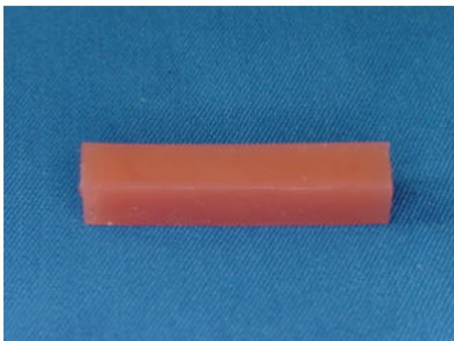
FIGURA 13: Amostra para o ensaio de dureza Shore A concluída.
