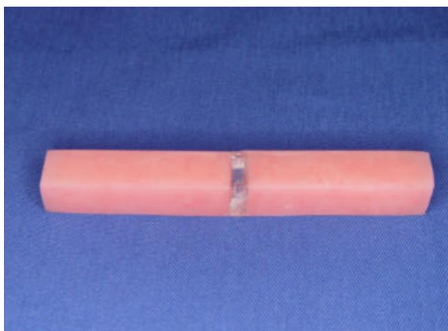
FIGURA 11: Amostra para o ensaio de resistência de união concluída.
