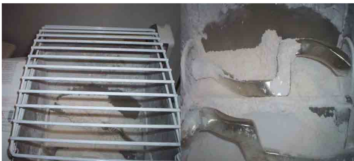
Figura 4- Misturador de farinhas de pás horizontais utilizados na homogeneização das misturas para os ensaios.
