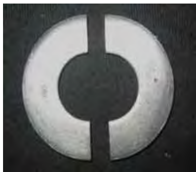
Figura 1A – Matriz metálica circular
