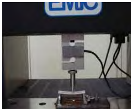
Figura 2 – Força axial no corpo de prova
