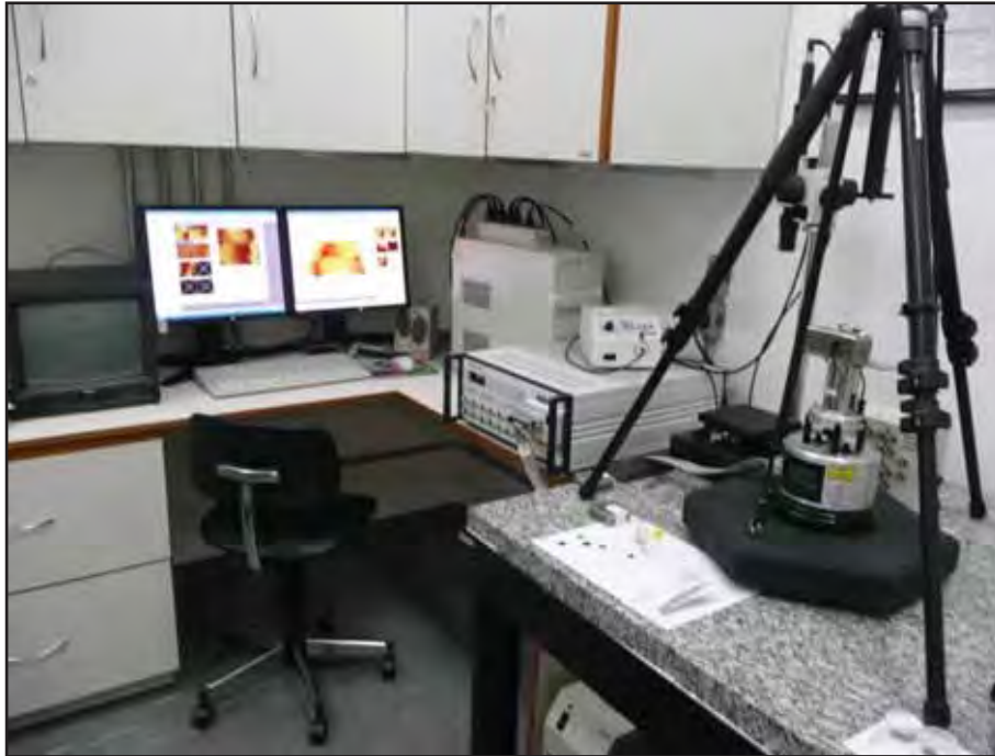
Figura 8 - Microscópio de força atômica empregado para análise da superfície
