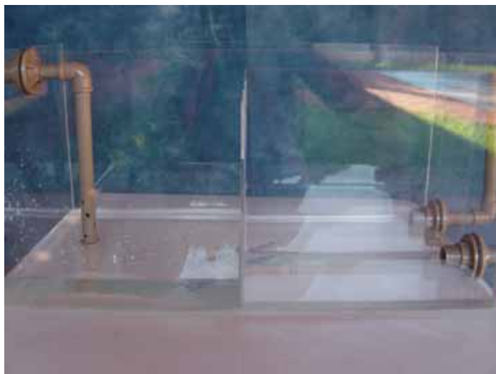
Figura 7: Teste de estanqueidade dos compartimentos.
