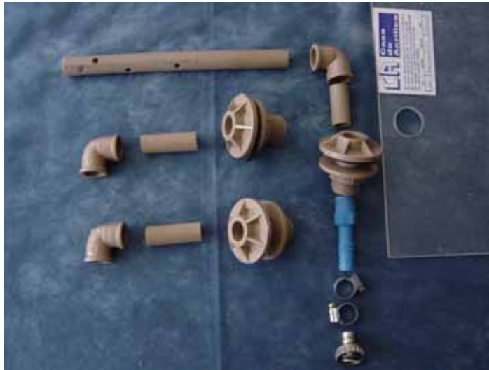
Figura 8: Tubulação e conexões de PVC utilizadas no modelo.
