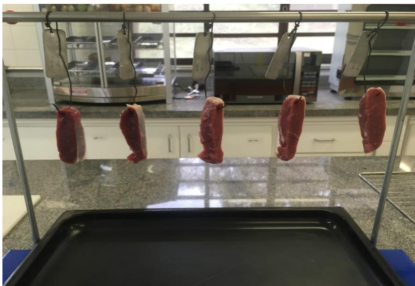
Figura 5. Revestimento das amostras de carne pela técnica de aspersão. Araraquara, SP, 2019.
