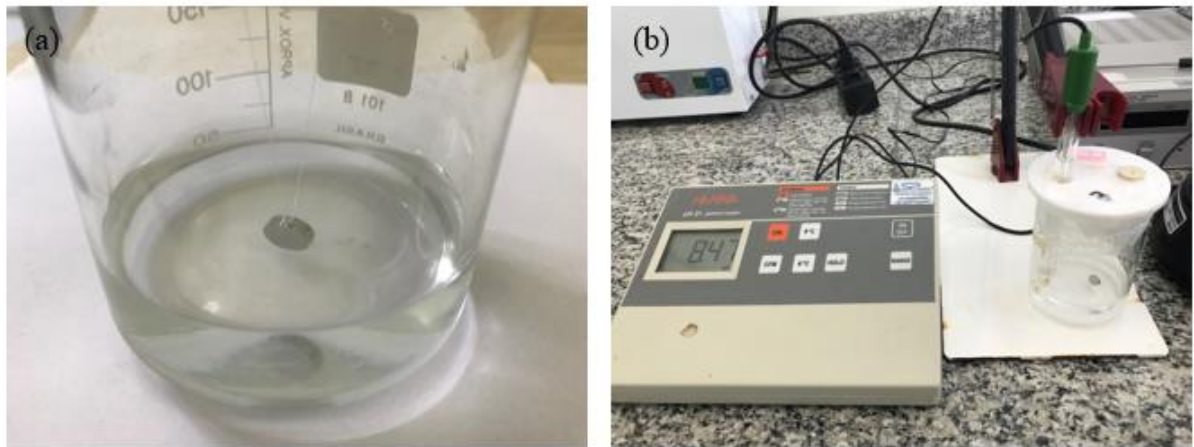
Figura 21 – (a) Disposição das amostras e (b) Monitoramento do pH durante o ensaio de imersão estática.
