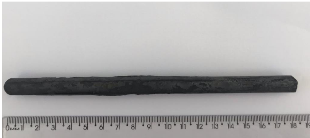
Figura 13 – Barras cilíndricas da liga Fe-35Mn obtidas após o forjamento a quente.
