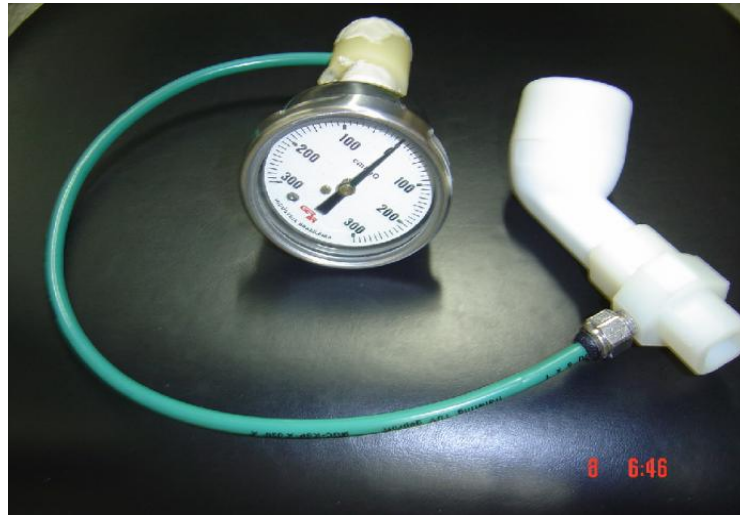
Figura 1 – Aparelho Flutter VRP1® acoplado a bucal específico para ser conectado ao manovacuômetro.
