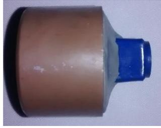
Figura 42– Monóculo colocado na luva de redução
