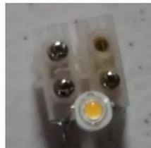
Figura 32 – LED de alta potência soldado nos terminais circulares
