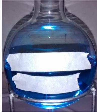
Figura 53– Marcação da Linha de nível de água.
