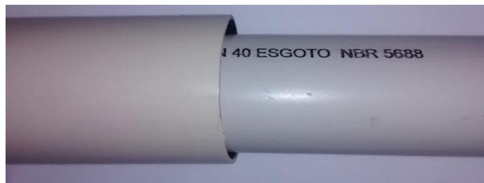
Figura 43– Encaixe dos tubos de 50mm e 40mm de diâmetro.
