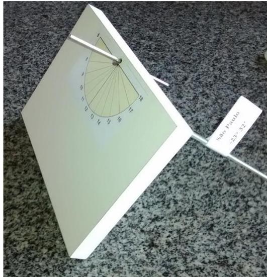
Figura 6– Montagem do Relógio do Sol
