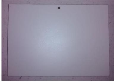
Figura 35– Peça retangular de compensado naval
