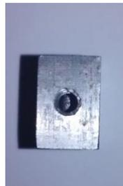
Figura 29 - Furo roscado na peça retangular na parte lateral
