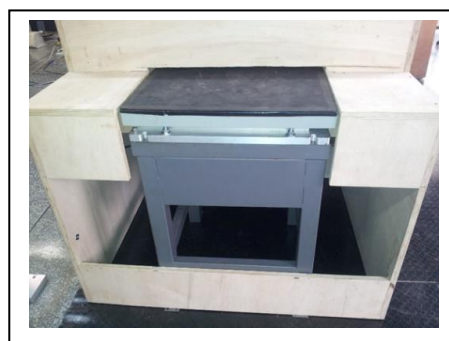
Figura 10 – Plataforma de força inserida no quarto degrau da escada experimental.
