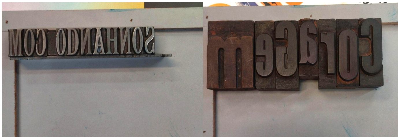
Figura 30 – Matrizes sobre as bolandeiras. Exemplo à esquerda de como foram utilizados os espaçadores.
