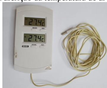
Figura 12: Sensor utilizado para a aferição da temperatura do ar nos transectos entre as 21h e as 22h
