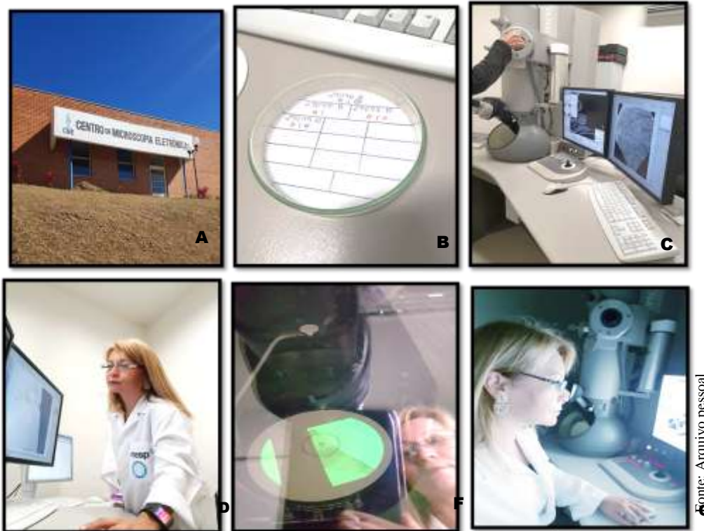
Figura 11 - Etapas da microscopia eletrônica: A - Centro de Microscopia Eletrônica – UNESP/Botucatu; B - Cortes ultrafinos; C - Inserção dos cortes no microscópio eletrônico; D - Padronização do microscópio; E - Localização dos campos para visualização dos glomérulos; F - Documentação elétron-micrográfica.
