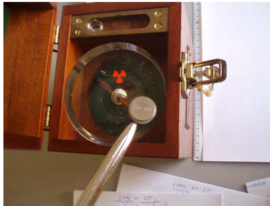
Figura 8 - Aplicador de estrôncio-90 utilizado em betaterapia[10].
