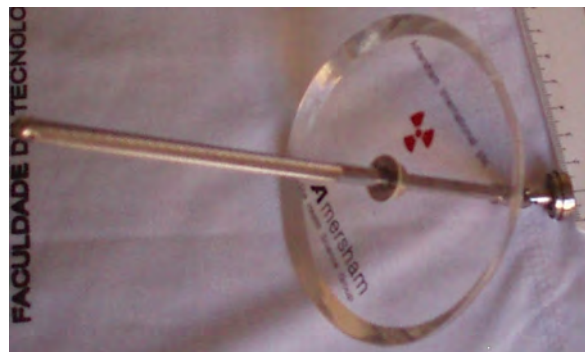
Figura 9 - Aplicador de estrôncio-90 utilizado em betaterapia[10].
