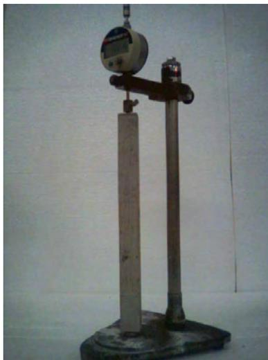
Figura 11 - Equipamento para medição de barra de argamassa
