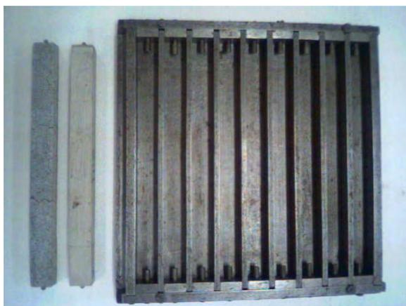
Figura 10 - Fôrma e barra de argamassa
