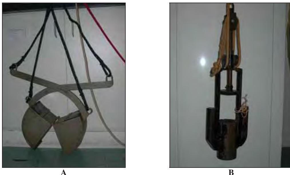
Figura 13. Coletor de sedimentos superficial tipo Van Veen (A) e coletor de testemunho de sedimentos tipo Kajak (B).
