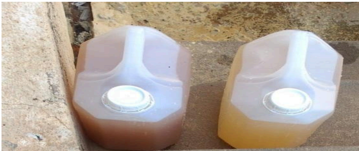
Figura 30 - Amostra da água residuária de retrolavagem do filtro 1 da ETA.
