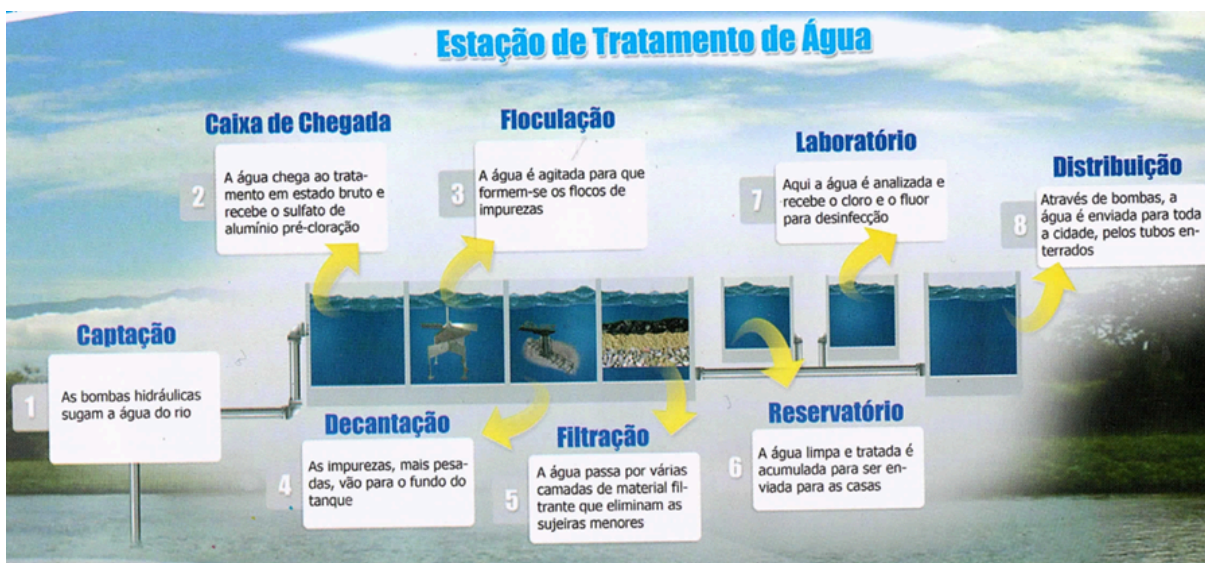
Figura 4 - Sistema de tratamento de água potável de Aparecida/SP.
