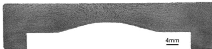
Figura 4.2 - Macroestrutura da amostra (F) na condição “como recebido” (Ataque com solução de iodo).
