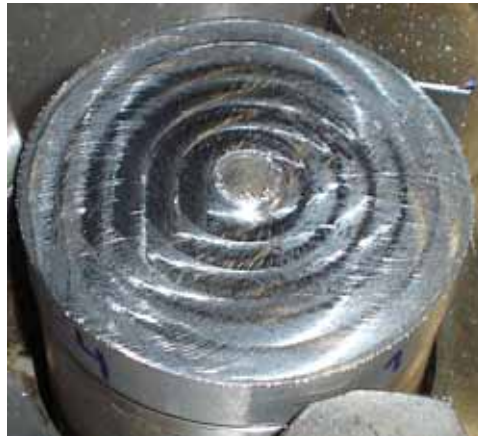
Figura 3.6 - Peça usinada utilizando trajetória circular.
