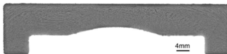
Figura 4.1 - Macroestrutura da amostra (N) na condição “como recebido” (Ataque com solução de iodo).
