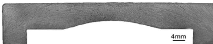
Figura 4.3 - Macroestrutura da amostra (A) na condição “como recebido” (Ataque com solução de iodo).
