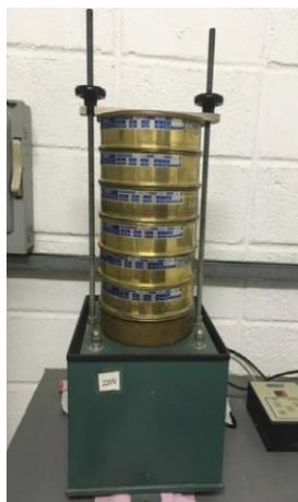
Figura 2 – Série padrão de peneiras, com abertura de malha de 4,80; 2,00; 1,13; 0,60; 0,425; 0,15 e 0,075 mm, utilizada para a análise granulométrica dos solos.
