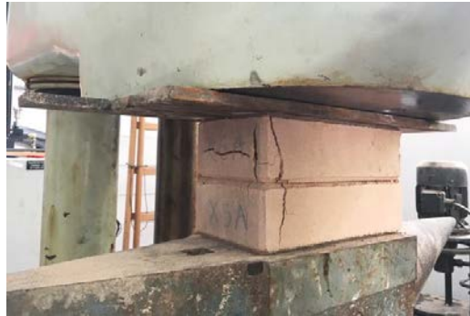
Figura 7 – Ensaio de compressão dos tijolos ecológicos.
