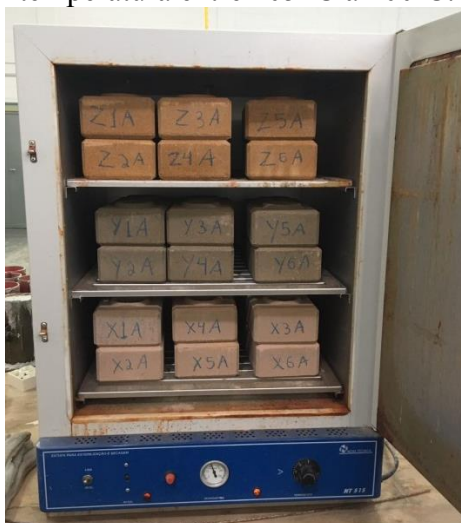
Figura 5 – Secagem das seis amostras de cada tipo de tijolo estudado, em estufa sob temperatura entre 105 °C a 100°C.
