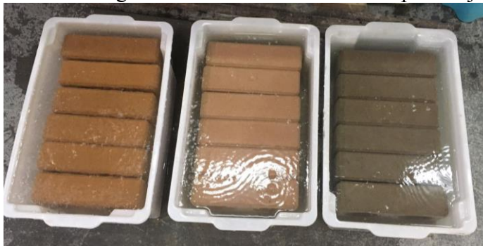
Figura 6 – Imersão em água das seis amostras de cada tipo de tijolo estudado.
