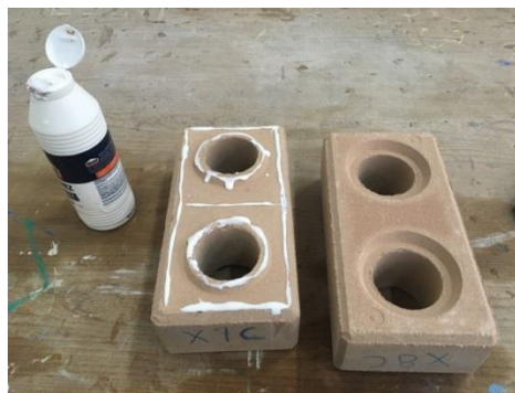
Figura 8 – Tijolos assentados com cola PVA branca sendo preparados para o ensaio de compressão simples.
