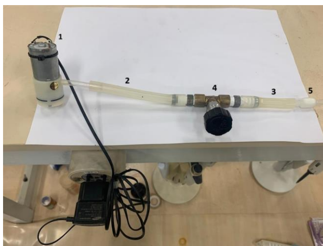
Figura 6. Amostrador ativo desenvolvido. 1- bomba de sucção do ar; 2 e 3 a mangueira plástica; 4 controle de vazão de gás que vai entrar no dispositivo, 5 a coluna C-18 .
