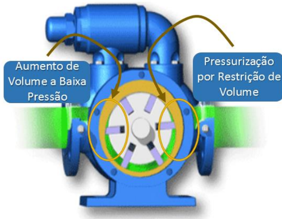
Figura 22 – Bomba de palhetas
